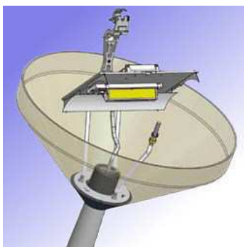
figuur 2.10 : armatuur met Unicliq systeem: zowel voor conventionele als LED lampen geschikt.
