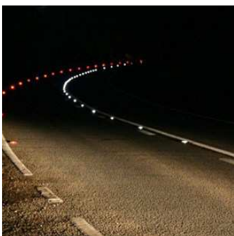
figuur 2.6 : verkeersveiligheid zonder verlichting, bijv.: schrikhek, reflecterende kattenogen.
